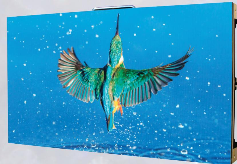
高輝度自発光デバイスであるLEDディスプレイは、高輝度、広視野角などの特徴を生かして屋外広告表示やスタジアムの電光掲示板等で使われてきましたが、近年、高精細化が進み、一般的なLCDディスプレイと比べても遜色ないレベルを実現しています。また、画面の大きさを設置環境に合わせて任意に決めたり、曲面に仕上げたりすることも可能です。高精細化を実現したことにより、オフィスエントランス、ショッピングモール等への活用と共に、交通インフラ等のコントロールルームでの使用等活動範囲を拡げています。
